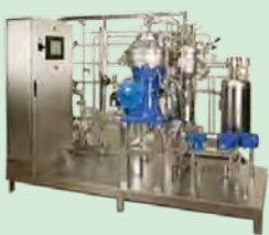
Culturefuge 100 形 Max. RCF : 12,440×g 沈降面積 : 11,500m 2 アルファ・ラバル(株)製
