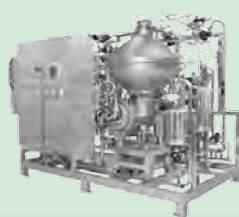
Culturefuge 400 形 Max. RCF : 7,400×g 沈降面積 : 180,200m 2 アルファ・ラバル(株)製
