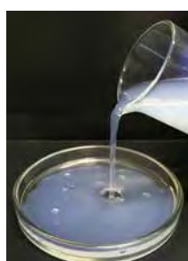
シリカ粒子スラリー （粒子径約700nm）
