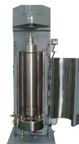
AT-8 形 Max. RCF: 20,000xg ローター呼称容量: 8L エス・シー・テクノ社製
