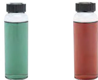
金属性単層CNT 半導体性単層CNT (写真提供: 株式会社ナノカーボン様)
