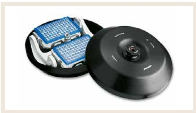
図2: 遠心機用のスイングバケットローター
