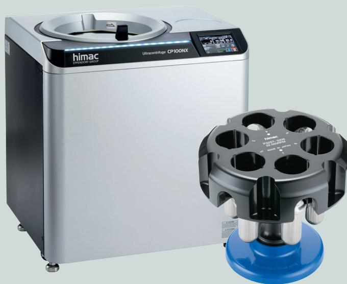
図 3 – Centrifuge CP100NX と Rotor P32ST
