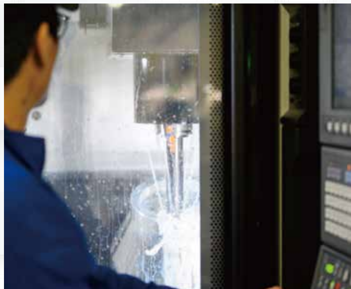
最新マシニングセンタでのローターの加工現場
