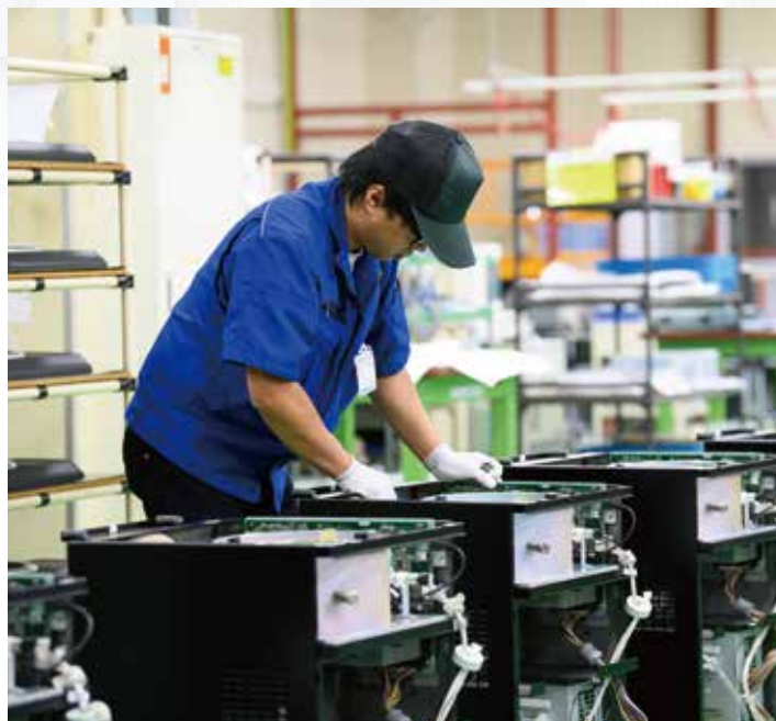
専門知識を習得した作業員による遠心機組立て
