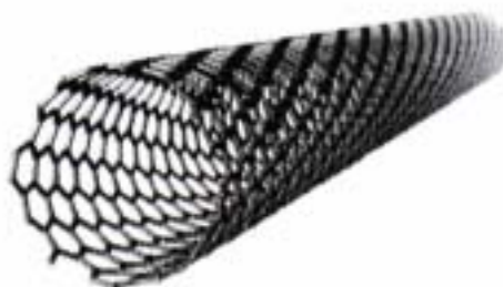
図1 単層カーボンナノチューブのモデル例
