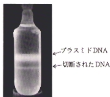
Fig. 1 トリフルオロ酢酸セシウム使用 エチジウムブロマイド: 1 \mu\text{g}/\text{ml} RP120VT パーティカルロータ 120,000min -1 (rpm)、3時間、20℃
